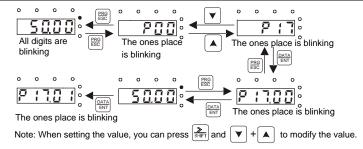
Figure 5-7 Viewing a parameter
